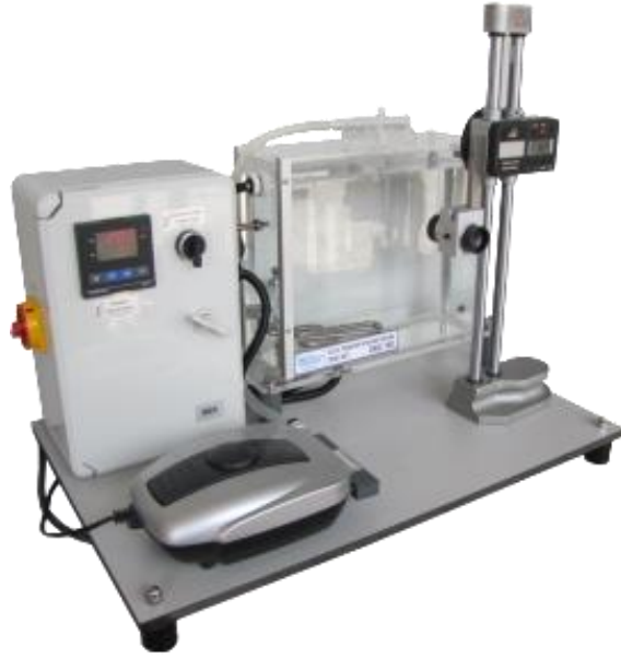
Şekil 3.1. Gaz difüzyon katsayısı belirleme deney düzeneği.
