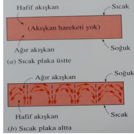
Şekil-8: Yatay bir kapalı aralıkta (a) sıcak plaka üstte ve (b) sıcak plaka altta olma durumundaki taşınım akımları
