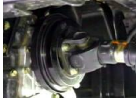
Şekil 24: Transmisyon çıkış mili üzerine yerleştirilen el freni
