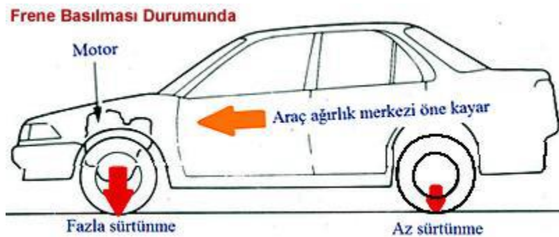
Şekil 25: Frenleme esnasında araçta ağırlık dağılımı
