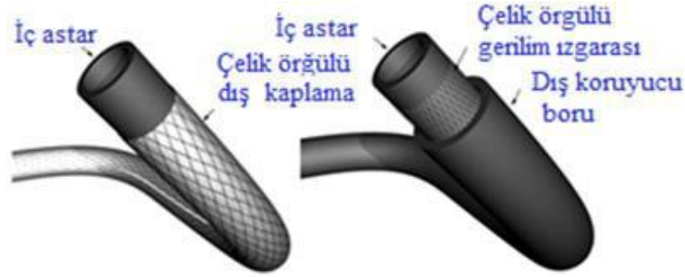
Şekil 10. Fren hortumlarının iç yapısı
