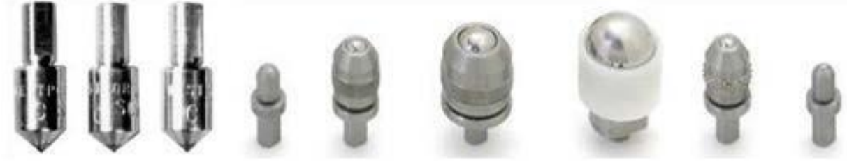
Şekil 4. Rockwell yöntemine ait batıcı uçlar
