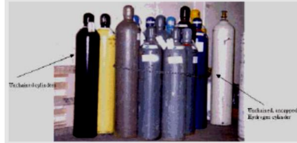
Resim 4.4.2. Gaz silindirleri her zaman zincir ile sabitlendirilmeli, kullanılmadığı zaman kapakları kapatılmalıdır [11].
