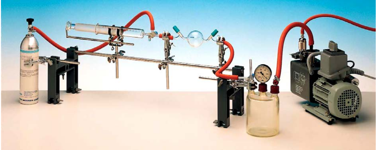
Şekil 6.1: Bir Gazın Molar Kütlelerinin Hesaplanması Deney Düzenegi Kurulumu.
